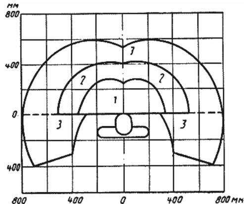
1 - зона для размещения очень часто используемых и наиболее важных органов управления (оптимальная зона моторного поля); 2 - зона для размещения часто используемых органов управления (зона легкой досягаемости моторного поля); 3 - зона для размещения редко используемых органов управления (зона досягаемости моторного поля)
