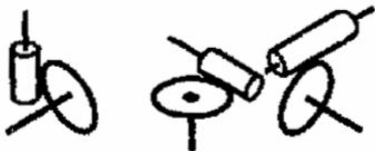
8. Передача винтовыми зубчатыми колесами
