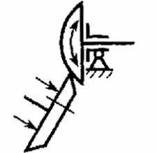
ж) с цилиндрическими роликами, преобразующие вращательное движение в поступательное
