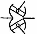
г) с криволинейными образующими рабочих тел и наклоняющимися роликами регулируемые
