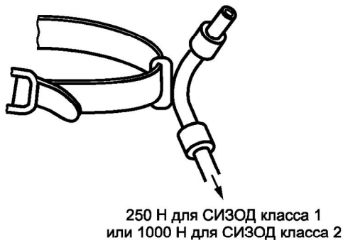
Рисунок 6 — Схема испытания прочности шланга подачи воздуха
